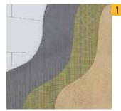
Штукатурки, использующие в своей технологии армирующую сетку, немного проигрывают по скорости, но позволяют предотвратить возможность возникновения мелких трещин
