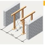
При этом расстояние между подпорными рейками и расстояние между опорными столбами (стойками). удерживающими одну и ту же подпорную рейку, должны быть не более 1.6 м.
